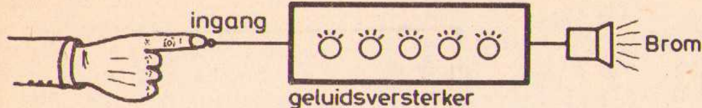
Fig. 2 Brom uit de luidspreker als gevolg van aanraking van de versterkeringang.
